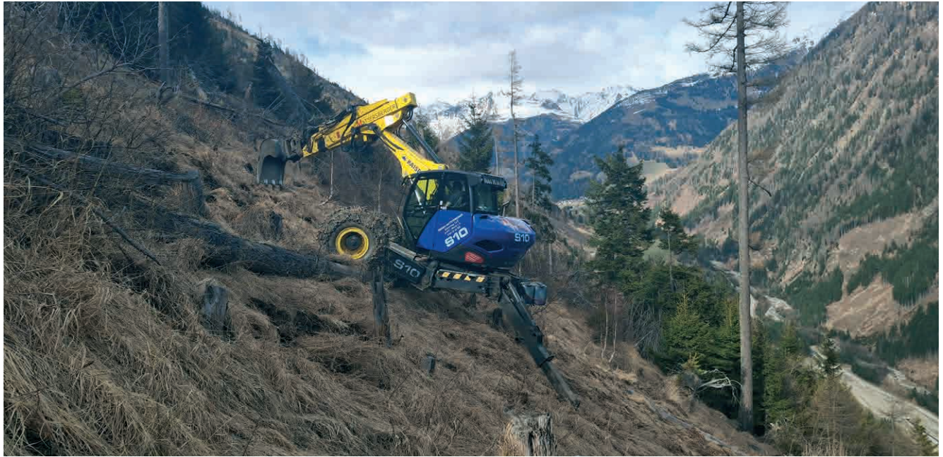
Schlagvorbereitung Mattersberger Schreitbagger
